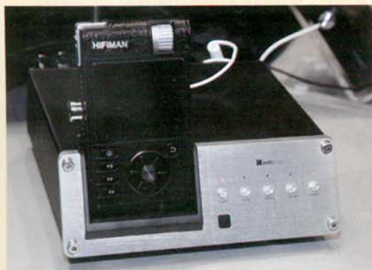
HIFIMAN Docking Station插上HM-901後可作USB DAC，並有齊RCA和同軸輸出。
